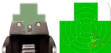
Рис. 33. Пример смещения мушки в прорези прицела одновременно в вертикальной и горизонтальной плоскостях и соответствующее этому случаю расположение траектории прицеливания и виртуальной пробоины.
