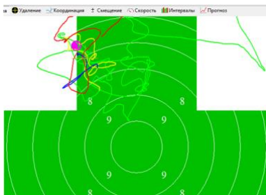
Рис. 11. Мушка сместилась в прорези целика влево – \approx на 0,6 мм и вверх – \approx на 1 мм.
